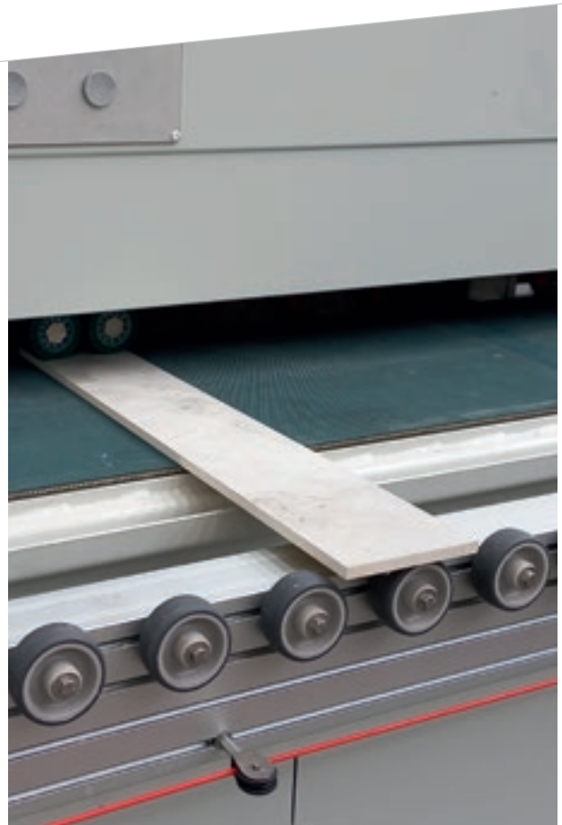
Roues de presseurs duplex pour longueur de tête min de 150 mm.
